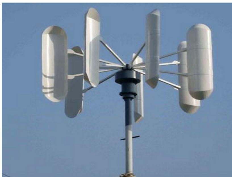
Рис 3. Ветрогенератор с вертикальной осью вращения
